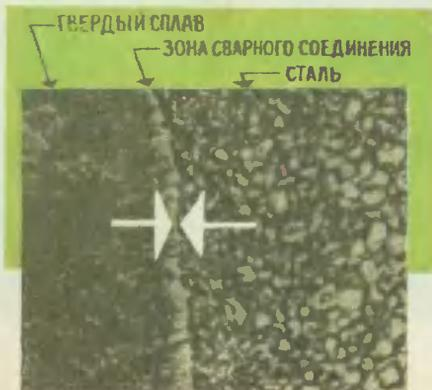
Под микроскопом сваренные детали: одна из них из твердого сплава, другая из обычной стали. В таких соединениях уже можно различить границу диффузии.
